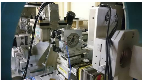
図3 開発したヒーターを組み込んだダイヤモンドアンビルセルをSPring-8のBL35XUにある非弾性散乱分光計に搭載したところ。
